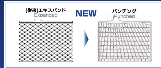
パンチング式の極板採用(プラス)により
