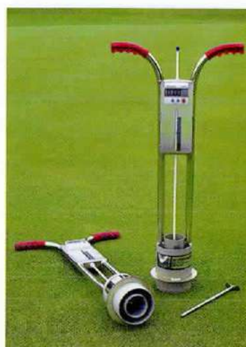
1000 インフィルトロメーター(水浸透速度計) 150Φ×830mm スチール製 ターフエリア専用の水の浸透速度を現場 で測定することができます。浸透速度 データーを散水管理に生かすこともで き、エアレーション、バーチカット、 トップドレッシング等の作業効果を数 字で把握することができます。浸透速度が 「2.5cm/h以下」のグリーンは危険の境界 線上にあると理解すべきです。(ターフ テック社製)
