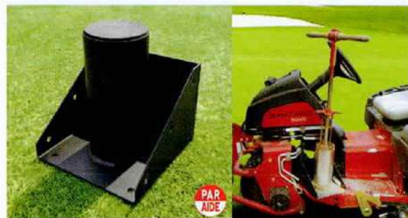
504-F ホールカッターキャリア 200×200×220mm スチール製 ホールカッターを安全且つ刃を傷めずに運ぶためのツールです。グリーンマ スター等に取り付けておく事で、作業効率も上がります。取付方法はボルト での固定式となっています。
