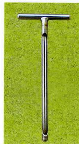
517-C ソイルテスターミニ 19Φ×205×525mm 474g スチール製 持ち運びに便利なサイズのソイ ルテスターです。 深さ 375mm・幅(径) 約 19Φmm の土壌サンプルを抽出できます。 土壌分析にお役立てください。
