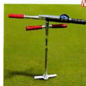
538 New シェアストリングステスター 850mm 先端部 ステンレス製 本体 亜鉛メッキ製 ハードケース付き 重量3.4kg 芝の水平方向のせん断力を計測す る器具です。先端部を芝に差し込み、 芝が裂け始めるまでハンドルを回す とせん断力が計測できます。
