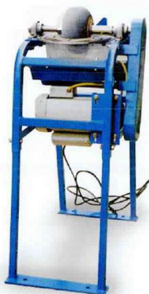
504-T ホールカッター研磨機 丸砥石使用 390×600×830Hmm モーター:0.2KW/100V/3.7A 砥石タイプのホールカッター研磨機が登場。チェーン駆動を採用し、砥石の回転口 スがありません。刃先の角度を変えずに 短時間で研磨できます。水で冷却し焼き 戻りが出ません。
